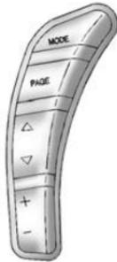
Die Bedienelemente des Head-up-Displays (HUD) befinden sich an der linken Seite des Lenkrades.
