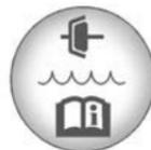
Der Deckel des Flüssigkeitsbehälters der hydraulisch betätigten Kupplung ist mit diesem Symbol gekennzeichnet. Einbauort des Behälters siehe *Motorraumübersicht auf Seite 10-8*.
