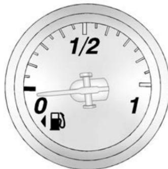
Die Kraftstoffuhr zeigt an, wie viel Kraftstoff das Fahrzeug noch hat, während der Motor eingeschaltet ist.
