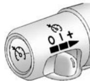
Die Bedienelemente für den Geschwindigkeitsregler befinden sich am Ende des Multifunktionshebels.
