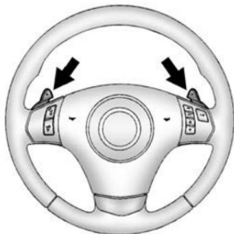
Die manuelle Tippschaltung kann in der Fahrposition (D) oder im Sport-Modus (S) verwendet werden. Das System wird durch Drücken des Tippschalters über den Lenkradspeichen aktiviert: Zum manuellen Hochschalten in den nächsten Gang drücken Sie den Tippschalter nach hinten; zum Herunterschalten ziehen Sie ihn nach vorne. Der aktuelle Gang wird im Driver Information Center (DIC)
