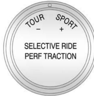
Dieser Knopf befindet sich in der Mittelkonsole. Durch Drehen können Sie den gewünschten Federungsmodus einstellen. Nach dem Loslassen springt der Knopf in die Mittelstellung zurück. Die aktuelle Fahrwerkseinstellung wird eine leuchtende Anzeige im Schalter angezeigt.
