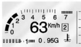
Der Modus Track 2 (Piste 2) unterstützt Gravitationskraftmesser, Ladedruckmesser mit ZR1 und untergeordnete Instrumente mit linearem Drehzahlmesser.
