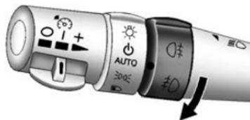
Das Fahrzeug ist mit Nebelschlussleuchten ausgestattet.
