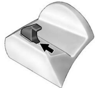
2. Das Dach so in das Staufach einsetzen, dass die äußeren Vorderkanten zwischen den Staufachabdeckungen liegen. Schieben Sie das Dach bis zum Anschlag nach vorne.
