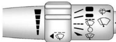
Der Hebel für die Scheibenwischer und die Waschanlage befindet sich auf der rechten Seite der Lenksäule.
