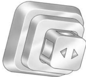
Bei Fahrzeugen mit Lenksäulen-Tiefenverstellung befindet sich der entsprechende Schalter auf der rechten Seite der Lenksäule.
