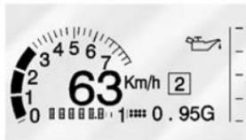
Der Modus Track 1 (Piste 1) unterstützt den Gravitationskraftmesser und untergeordnete Instrumente mit kreisförmigem Drehzahlmesser.
