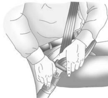
Zum Entriegeln des Gurtes drücken Sie den Knopf am Schloss. Der Gurt sollte in seine Ausgangsposition zurückkehren.
