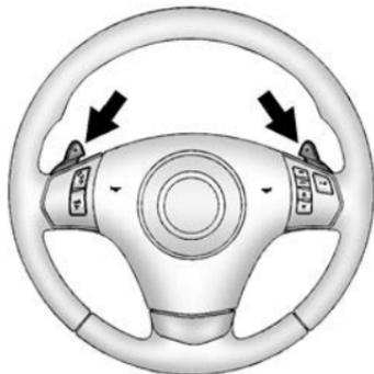
Das manuelle Schaltsystem wird im Sport-Modus (S) über den Tippschalter über den Lenkradspeichen aktiviert: Zum Hochschalten drücken Sie den Tippschalter nach hinten, zum Herunterschalten ziehen Sie ihn nach vorne.
