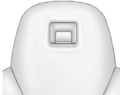
Um eine Sitzlehne vorzuklappen, heben Sie die Verriegelung oben auf Rückseite des Sitzes an. Die Sitzlehne rastet ein, wenn sie umgeklappt ist.
