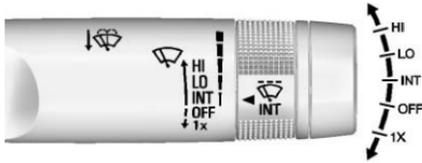
Der Hebel der Wisch-/Waschanlage befindet sich an der rechten Seite der Lenksäule. Während sich die Zündung in der Stellung ACC/ACCESSORY oder ON/RUN befindet, bewegen Sie den Scheibenwischerhebel, um die Wischgeschwindigkeit auszuwählen.
