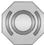
Der Behälterdeckel der Brems-/Hydraulikkupplungsflüssigkeit ist mit diesem Symbol gekennzeichnet.
