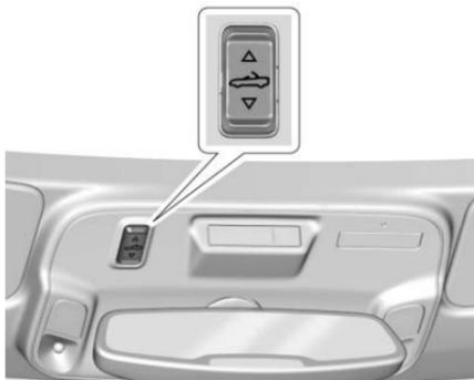
5. Drücken Sie lange auf den unteren Teil von
