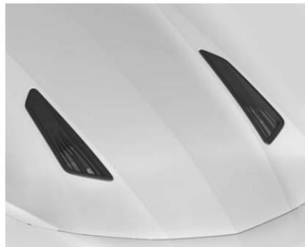
Die Entlüftung des SS sollte nicht gewachst werden, da dies den Oberflächenglanz verändern kann. Darüber hinaus müssen Sie beim Wachsen rund um die Entlüftung sorgsam vorgehen. Wenn eine kleine Menge Wachs auf die Entlüftung aufgetragen wird, kann dies die Oberfläche uneinheitlich aussehen lassen. Sollten Wachs, Fremdkörper oder andere Materialien Flecken auf der Entlüftung hinterlassen haben, wenden Sie sich bitte an Ihren Händler, um Informationen zum empfohlenen Reinigungsmittel zu erhalten.
