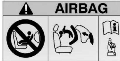
Verwenden Sie KEINEN rückwärtsgerichteten Kindersitz auf dem Beifahrersitz. Es besteht die GEFAHR TÖDLICHER ODER SCHWERER VERLETZUNGEN! Ein Auslösen des Airbags kann bei nach hinten ausgerichteten Babyschalen schwere Verletzungen des Kindes nach sich ziehen.
