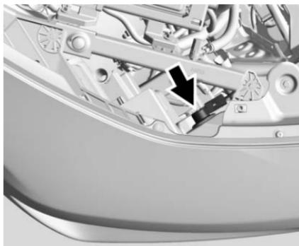
2. Die Leuchtenfassung des Blinkers an der Innenseite der Blinkerleuchte lokalisieren.
