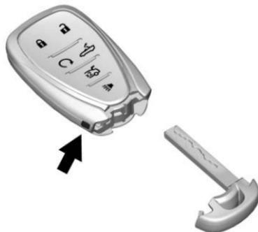
1. Die Taste an der Seite des Transmitters drücken und den Schlüssel herausziehen.
