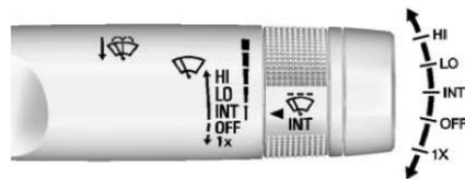
Der Hebel für die Scheibenwischer und die Waschanlage befindet sich auf der rechten Seite der Lenksäule. Während sich die Zündung in der Stellung ACC/ACCESSORY oder ON/RUN befindet, bewegen Sie den Scheibenwischerhebel, um die Wischgeschwindigkeit auszuwählen.
