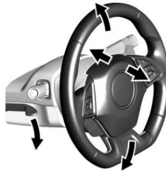
Höhenverstellbares Lenkrad und Teleskoplenksäule einstellen:
