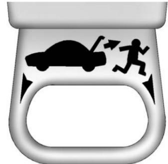
An der Kofferraumverriegelung des Kofferraums gibt es einen Notentriegelungsgriff, der im Dunkeln leuchtet. Der Griff beginnt zu leuchten, nachdem er angestrahlt wurde. Ziehen Sie am Entriegelungsgriff, um den Kofferraum von innen zu öffnen.
