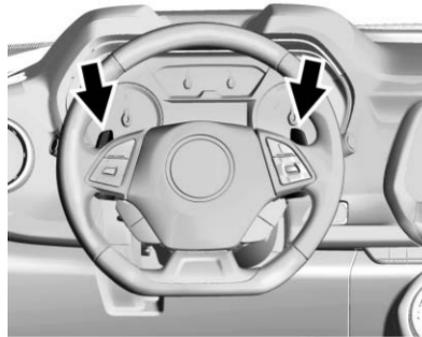
Das System lässt sich durch Drücken eines der mit REV MATCH gekennzeichneten Tippschalter am Lenkrad ein- und ausschalten. Das System muss bei jedem Einschalten der Zündung neu aktiviert werden.
