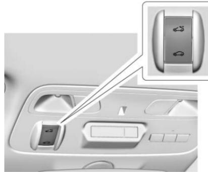
Das Schiebedach kann nur betrieben werden, wenn die Zündung in der Stellung ON/RUN oder ACC/ACCESSORY steht oder die verlängerte Stromversorgung (RAP, Retained Accessory Power) aktiv ist. Siehe *Zusätzlicher Energiespeicher (RAP)* ↗ 194.
