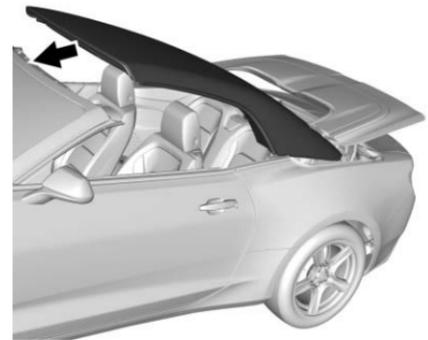
2. Verdeck anheben und von beiden Seiten am Bügel nach vorne in die vollständig geschlossene Stellung ziehen.
