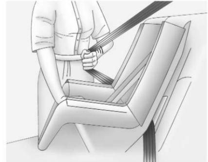
4. Ziehen Sie den Schultergurt ganz aus dem Gurtaufroller heraus, um die Blockierung einzustellen. Wenn die Blockierung des Gurtaufrollers eingestellt ist, kann der Gurt gestrafft werden aber nicht aus dem Gurtaufroller gezogen werden.
