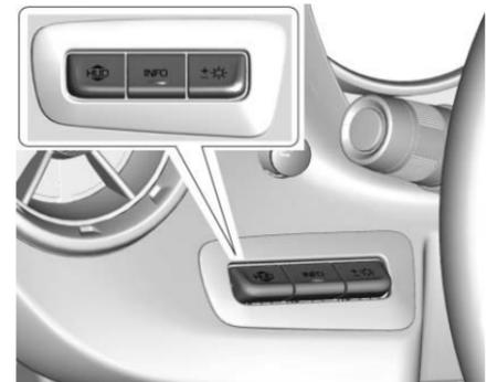
Das Bedienelement für das Head-up-Display befindet sich links neben dem Lenkrad.
