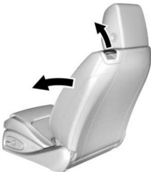
Um Zugang auf die Rücksitze zu erhalten, den Riegel oben an der Fahrer- oder Beifahrersitzlehne nach oben ziehen. Klappen Sie die Sitzlehne nach vorne.
