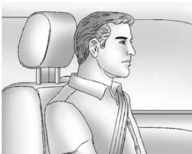
Stellen Sie die Kopfstütze so ein, dass sich deren Oberkante auf gleicher Höhe mit der Oberseite des Kopfes des Insassen befindet. In dieser Position wird die Wahrscheinlichkeit einer Nackenverletzung bei einem Unfall verringert.
