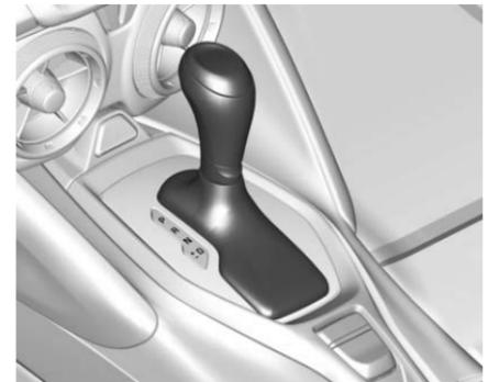
**P** : Diese Stellung blockiert die Hinterräder. Diese Stellung bietet sich beim Anlassen des Motors an, da das Fahrzeug nicht leicht ins Rollen geraten kann.
