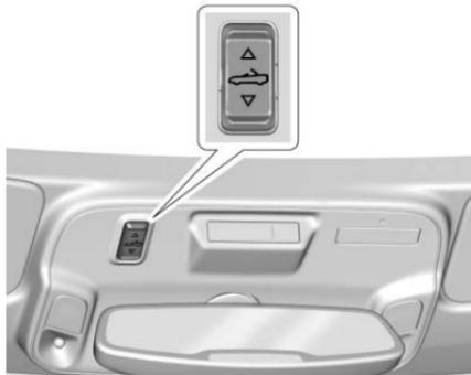
6. Drücken Sie lange auf den oberen Teil von
