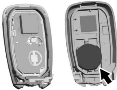
3. Die Batterie herausnehmen. Dazu auf die Batterie drücken und sie in Richtung des unteren Transmitterrands schieben.
