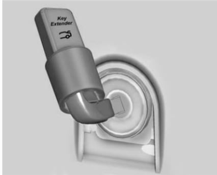
6. Die Schlüsselverlängerung bis zum Anschlag Schlüsselkopf aufstecken.
