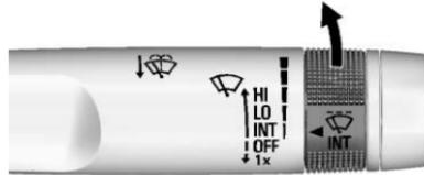
**INT** : Für Wischintervalle bringen Sie den Hebel in die Position INT und drehen Sie dann den Ring
