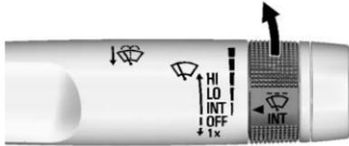
**INT** : Für Wischintervalle bringen Sie den Hebel in die Position INT und drehen Sie dann den Ring
