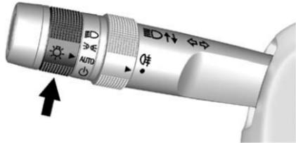
Die Einstellung der Außenbeleuchtung erfolgt über den Blinkerhebel.
