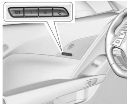
Sofern vorhanden, werden mit den Tasten 1, 2, SET und
