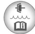
Der Deckel des Flüssigkeitsbehälters der hydraulisch betätigten Kupplung ist mit diesem Symbol
