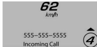
**Mobiltelefon** : Kann angezeigt werden, wenn auf einem per Bluetooth verbundenen Mobiltelefon ein Anruf eingeht. Wird kurzzeitig eingeblendet, bis der Anruf angenommen bzw. ignoriert wird.
