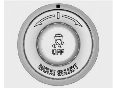
Die TCS/StabiliTrak-Taste befindet sich in der Mittelkonsole.
