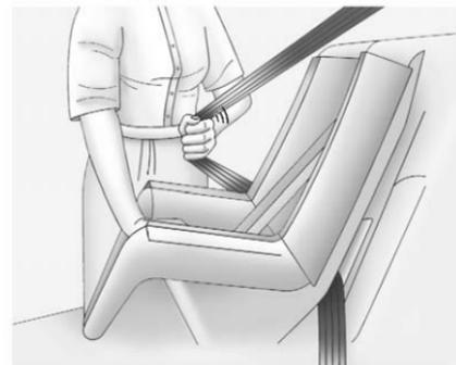
5. Ziehen Sie den Schultergurt ganz aus dem Gurtaufroller heraus, um die Blockierung einzustellen. Wenn die Blockierung des Gurtaufrollers eingestellt ist, kann der Gurt gestrafft werden aber nicht aus dem Gurtaufroller gezogen werden.
