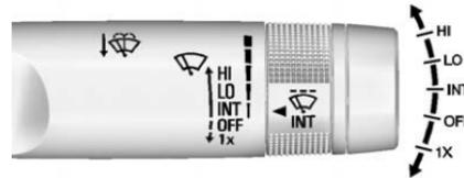
Der Hebel für die Scheibenwischer und die Waschanlage befindet sich auf der rechten Seite der Lenksäule.
