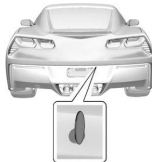
Verwenden Sie den Schlüssel, um den Kofferraum zu öffnen.
