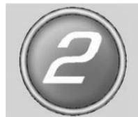
Bei Verwendung des manuellen Schaltmodus im Manuell-Modus (M) wird der aktuelle Gang im Instrument bzw. im Head-up-Display (falls vorhanden) angezeigt. Siehe *Head-up-Display* ⇨ 130.
