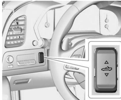
6. Drücken Sie lange auf den oberen Teil von
