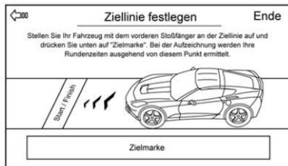
Zum Festlegen der Ziellinie das Fahrzeug mit dem Frontstoßfänger am Start-/Zielpunkt positionieren. Im PDR-Menü die Taste Ziellinie festlegen und dann Zielmarke drücken. Dies kann bei sich bewegendem Fahrzeug erfolgen.
