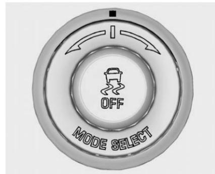
Der Knopf für die Fahrmodusauswahl befindet sich in der Konsole hinter dem Schalthebel.
