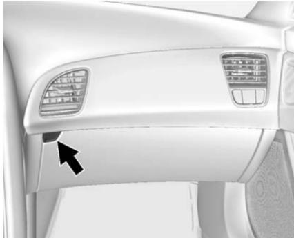
Zum Öffnen den Knopf drücken. Sofern verfügbar, wird das Handschuhfach bei Aktivieren des Spermodus verriegelt. Siehe *Fahrzeugpersonalisierung* ⇨ 147.
