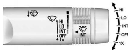
Der Hebel der Wisch-/Waschanlage befindet sich an der rechten Seite der Lenksäule.
