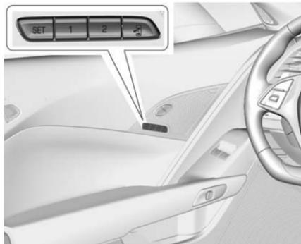
Bei Modellen mit Speicherfunktion werden mit den Tasten 1, 2, SET und
