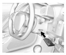
Den Transmitter in das Transmitterfach in der Lenksäule einlegen, wobei die Tasten nach oben und die Unterseite zum Beifahrer hin zeigen müssen.
