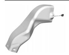
7. Die U-Mutter auf dem oberen Kanal positionieren.
