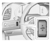
Drücken Sie lange auf den oberen Teil von Die Fenster werden automatisch geöffnet.  Nachdem das Verdeck komplett geschlossen ist, ertönt ein Warnton und erscheint eine Meldung im DIC. Den Schalter loslassen. Schließen Sie ggf. die Fenster.
