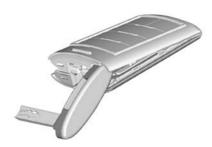
Trennen Sie die beiden H\u00e4lften des Transmitters mithilfe der ovalen Grundplatte des Schl\u00fcsselblatts.
