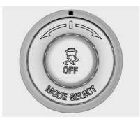
Drehen Sie den Knopf MODE SELECT (Magnetic Ride Control/ Performance Traction Management) in der Mittelkonsole, um bei aktivem PTM einen Modus auszuwählen.
