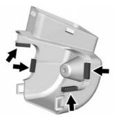
Das Klebeband von den Gummi-Pads entfernen und diese wie dargestellt an der hinteren Airbox installieren. Fünf Minuten trocknen lassen.
