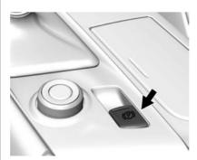
Das Fahrzeug hat eine elektrische Parkbremse (EPB). Die elektrische Feststellbremse lässt sich zu jeder Zeit aktivieren, auch bei ausgeschalteter Zündung. Um ein Entladen der Batterie zu verhindern.
