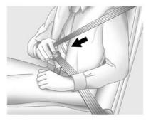
Erfassen Sie die Schlosszunge und ziehen Sie den Gurt über Ihren Körper. Achten Sie darauf, dass sich der Gurt nicht verdreht! Der Dreipunktgurt kann blockieren, wenn Sie ihn sehr schnell über Ihren Körper ziehen. Sollte dies geschehen, lassen Sie den Gurt kurz zurückgleiten, um die Blockierung aufzuheben. Ziehen Sie ihn anschließend etwas langsamer über Ihren Körper.
