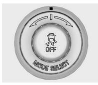
Die TCS/StabiliTrak-Taste befindet sich in der Mittelkonsole.
