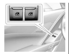
Die elektrische Fensterbetätigung funktioniert nur, wenn das Fahrzeug eingeschaltet ist bzw. die Zündung auf ACC/ACCESSORY (Zubehör) steht oder die aufrechterhaltene Spannungsversorgung (RAP) aktiv ist. Siehe Zusätzlicher Energiespeicher (RAP) ⇒ 203.
