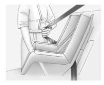
. Ziehen Sie den Schultergurt ganz aus dem Gurtaufroller heraus, um die Blockierung einzustellen. Wenn die Blockierung des Gurtaufrollers eingestellt ist, kann der Gurt gestrafft werden aber nicht aus dem Gurtaufroller gezogen werden.
