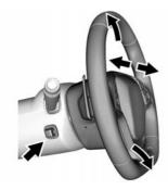
Drücken Sie auf das Bedienelement, um das elektrisch verstellbare Lenkrad nach oben und unten bzw. nach vorne und hinten zu bewegen.
