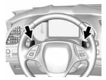
Wenn der Wählhebel auf M (Manuell-Modus) gestellt wird, wird der Manuell-Modus des Getriebes aktiviert. Der aktuell eingelegte Gang wird so lange beibehalten, bis ein Gangwechsel angefordert wird. Mit den Schaltwippen am Lenkrad kann manuell hoch- oder heruntergeschaltet werden. Die rechte Plus-Schaltwippe (+) dient zum Hochschalten, die linke Minus-Schaltwippe (–) zum Herunterschalten
