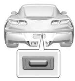
Das Entriegelungs-Touchpad an der Heckklappe, um die Heckklappe zu öffnen, wenn sich der RKE-Transmitter in einer Entfernung bis zu 1 m (3 ft) befindet.
