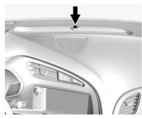
Die Kontrollleuchte auf dem Armaturenbrett in der Nähe der Windschutzscheibe zeigt den Status des Systems an. **Aus :** Die Alarmanlage ist deaktiviert.
