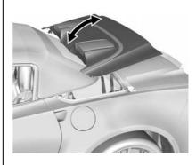
Stellen Sie sich jeweils auf eine Seite des Verdeckkastendeckels, heben Sie ihn an und schwenken Sie ihn nach hinten in die vollständig geöffnete Position.
