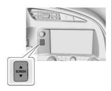
Drücken Sie die Taste, um das Display nach unten zu fahren und auf das dahinterliegende Staufach zuzugreifen.
