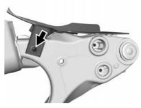
Das Ableitblech des Lenkers mit der Schraube am oberen Kanal einbauen. Noch nicht festziehen.
