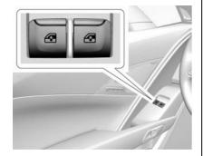
Die elektrische Fensterbetätigung ist funktionsfähig, wenn die Zündung auf ON oder ACC/ACCESSORY (ZUBEHÖR) steht oder RAP (aufrechterhaltene Versorgungsspannung) aktiv ist. Siehe Zusätzlicher Energiespeicher (RAP) ⇒ 203.
