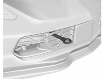
Die Aufnahme für den vorderen Abschlepphaken ist über die Öffnung im Kühlergrill zugänglich.
