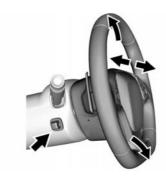
Drücken Sie auf das Bedienelement, um das elektrisch verstellbare Lenkrad nach oben und unten bzw. nach vorne und hinten zu bewegen.
