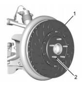
Die Bremsscheibe (1) mit dem Befestigungselement (2) einbauen. Auf 10 N•m (89 lb in) festziehen.
