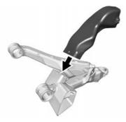
Den oberen Kanal positionieren und in die Laschen der vorderen und hinteren Airbox-Baugruppe einrasten.
