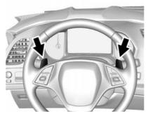
Die manuelle Tippschaltung kann in der Fahrposition (D) oder im Manuell-Modus (M) verwendet werden. Das System wird durch Drücken des linken Tippschalters (Herunterschalten) oder des rechten Tippschalters (Hochschalten) aktiviert. Der aktuelle Gang wird im Instrument und im Head-up-Display (sofern vorhanden) angezeigt.
