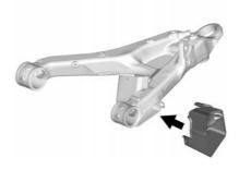
Die hintere Airbox positionieren und die Laschen in die vordere Airbox um den Unterlenker herum einrasten.
