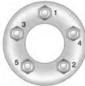
12. Serrer les écrous de roue fermement en croix, selon le schéma.
