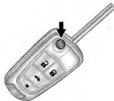
Appuyer sur la touche de relâche de clé pour sortir la lame de clé. La clé peut être utilisée pour l'allumage et toutes les serrures.
