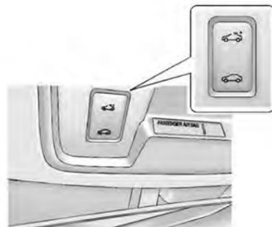
Le toit ouvrant peut être ouvert sans maintenir le commutateur abaissé. Pousser le commutateur dans le sens de l'ouverture jusqu'à la seconde pause. Le toit ouvrant s'ouvre complètement.
