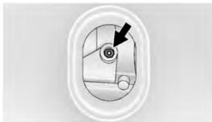
5. Localiser le boulon de détente de pression du haut de la pompe hydraulique.
