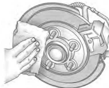
8. Nettoyer toute trace de rouille ou de saleté sur les boulons de roue, les surfaces de montage et la roue de secours.
