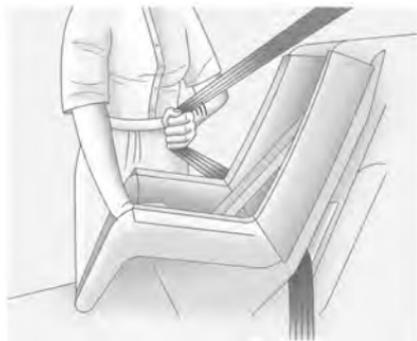
4. Tirer complètement la sangle thoracique hors de l'enrouleur pour engager le système de blocage. Lorsque le système de blocage de l'enrouleur est engagé, la ceinture peut être serrée, mais ne peut être tirée hors de l'enrouleur.
