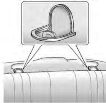
Sur les coupés, les ancrages d'attache supérieurs se trouvent sur le panneau de remplissage de dossier de siège arrière.
