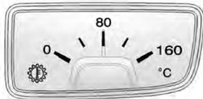
Pour les véhicules équipés de cet indicateur, l'indicateur se trouve devant le levier au changement de rapport et montre la température du
