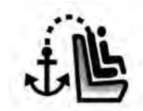
Pour vous aider à localiser les ancrages de harnais supérieurs, le symbole d'ancrage d'attache supérieur se trouve sur le couvercle de l'ancrage.
