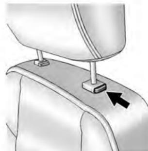
La hauteur des appuie-tête peut être réglée. Tirer sur l'appuie-tête pour le monter. Tenter de déplacer l'appuie-tête pour s'assurer qu'il est verrouillé en place.
