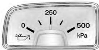
En cas de manomètre de pression d'huile, ce manomètre se trouve devant le levier au changement de rapport et indique la pression d'huile du moteur en kPa (kilopascals).
