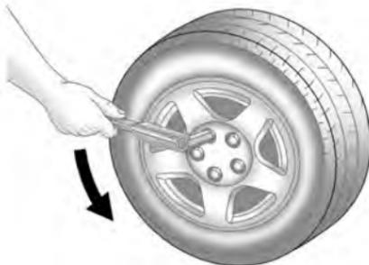
3. Utiliser la clé de roue complètement rallongée pour desserrer tous les écrous de roue d'un demi-tour dans le sens inverse des aiguilles d'une montre. Ne pas les déposer pour l'instant.
