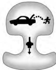
Il existe une poignée de déverrouillage d'urgence du coffre à l'intérieur du coffre sur la doublure, près du loquet du coffre. Sur certains véhicules, la poignée de déverrouillage est accessible en rabattant le dossier de siège arrière. Se reporter à *Sièges arrière* à la page 3-6.
