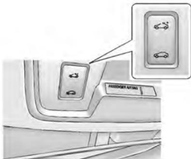
**Ouvrir/fermer:** Maintenir enfoncé l'arrière ou l'avant du commutateur pour ouvrir ou fermer le toit ouvrant.
