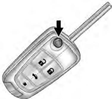
Appuyer sur le bouton de l'émetteur RKE pour éjecter la clé. Appuyer simultanément sur le bouton et sur la clé pour la replacer à l'intérieur de l'émetteur.
