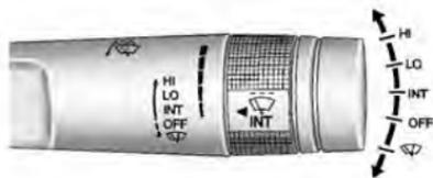
La manette d'essuie-glace/lave-glace avant se trouve sur le côté droit de la colonne de direction. Lorsque le contact est en position ACC/ACCESSORY (accessoires) ou ON/RUN (en fonction/marche), déplacer le levier d'essuie-glace pour sélectionner la vitesse de balayage.
