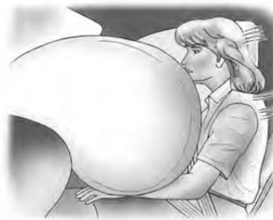
L'airbag frontal du passager avant droit se trouve dans le tableau de bord du côté passager.
