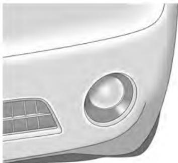
1. Trouver le bloc d'ampoule sous le carénage avant.
