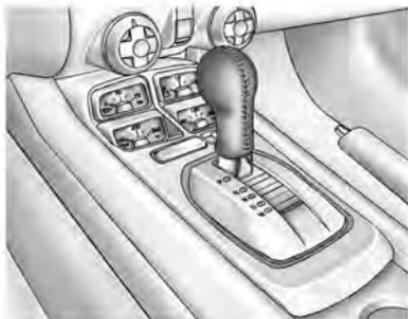
**P (stationnement):** Cette position bloque les roues arrière. C'est la meilleure position à utiliser pour démarrer le moteur parce que le véhicule ne peut pas se déplacer facilement.
