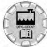
3. Tourner le bouchon de jauge du liquide de refroidissement du moteur dans le sens anti-horaire et retirer lentement la jauge.
