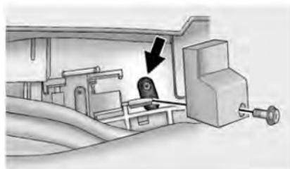
3. Déposer le dispositif de retenue et le cache du déverrouillage manuel du levier sélecteur.
