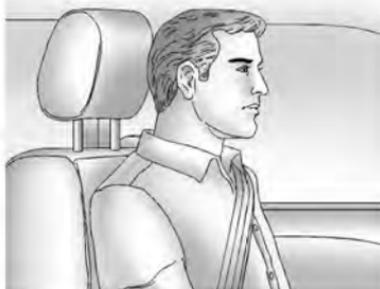
Régler l'appuie-tête de sorte que sa partie supérieure arrive au niveau du haut de la tête de l'occupant. Cette position réduit les risques de blessure à la nuque lors d'un accident.
