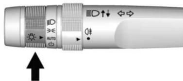
La commande de feux extérieurs se trouve sur le tableau de bord sur le côté extérieur du volant.
