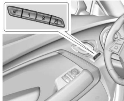
Sur les véhicules équipés, les sièges à mémoire permettent à deux conducteurs de mémoriser et rappeler chacun leur position de conduite et une position de sortie commune pour quitter le véhicule. D'autres positions de la fonction peuvent être également réglées, telles que les rétroviseurs électriques. Les positions mémorisées sont reliées à l'émetteur RKE 1 ou 2 pour les rappels automatiques.
