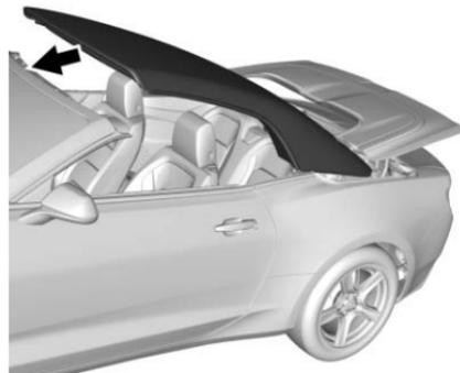
2. Soulever et déplacer le toit rétractable vers l'avant en tirant sur les deux côtés de l'arceau frontal pour l'amener en position complètement fermée.
