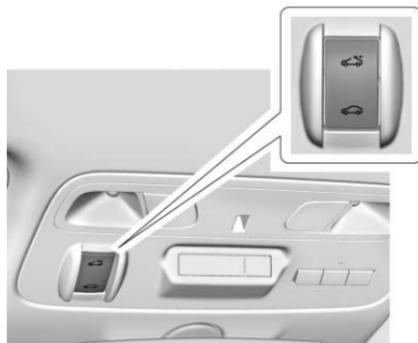
Selon l'équipement, le toit ouvrant à commande électrique fonctionne uniquement lorsque le contact se trouve en position en fonction/marche ou ACC/ACCESSORY (accessoires) ou lorsque la prolongation de l'alimentation des accessoires (RAP) est active. Consulter *Alimentation accessoires conservée* ⇨ 189.
