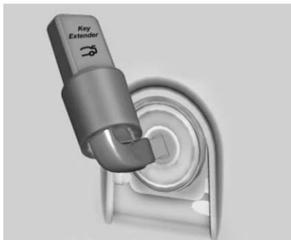
6. Placer le prolongateur de clé sur la tête de clé jusqu'à ce que le prolongateur soit en butée.
