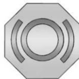
Le réservoir du maître-cylindre de frein/embrayage est rempli de liquide de frein DOT 3 approuvé par GM comme indiqué sur le bouchon du réservoir. Consulter *Vue d'ensemble du compartiment moteur* ⇨ 231 pour connaître l'emplacement du réservoir.
