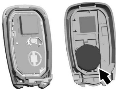
3. Retirer la pile en la poussant et en la faisant glisser vers le bas de l'émetteur.
