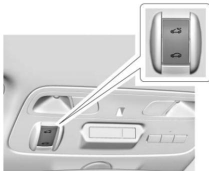
Selon l'équipement, le toit ouvrant ne fonctionne que lorsque le commutateur d'allumage est en position en fonction/marche ou ACC/ACCESSORY (accessoires) ou lorsque la prolongation de l'alimentation des accessoires (RAP) est active. Se reporter à *Alimentation accessoires conservée* ⇨ 189.
