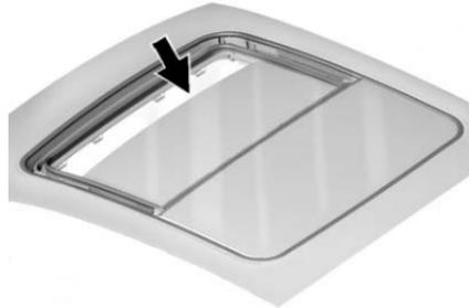
De la saleté et des débris peuvent s'accumuler sur le joint ou dans la glissière du toit ouvrant. Ceci peut causer un problème de fonctionnement ou de bruit du toit ouvrant. Le système d'écoulement d'eau peut également le toit ouvrant et retirer les obstacles ou les débris. Essuyer le joint du toit ouvrant et la zone d'étanchéité du toit avec un chiffon propre, du savon doux et de l'eau. Ne pas éliminer la graisse du toit ouvrant.
