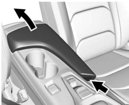
Appuyer pour ouvrir. Il existe un port USB et une prise auxiliaire à l'intérieur. Se reporter au manuel de l'infodivertissement.
