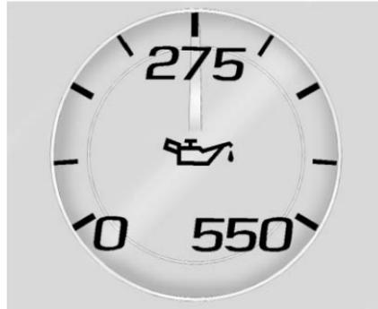
Le manomètre de pression d'huile moteur indique la pression de l'huile moteur en kPa (kilopascals) lorsque le moteur tourne.
