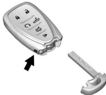
1. Appuyer sur le bouton sur le côté de l'émetteur et retirer la clé.
