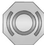
Le bouchon du réservoir de liquide d'embrayage/frein est doté de ce symbole. Consulter *Vue d'ensemble du compartiment moteur* ⇨ 231 pour connaître l'emplacement du réservoir. Le réservoir commun du liquide de maître-cylindre de frein et de l'embrayage hydraulique est rempli de liquide de frein comme indiqué sur le bouchon du réservoir. Consulter *Liquide de frein* ⇨ 249 pour le liquide de frein à utiliser.
