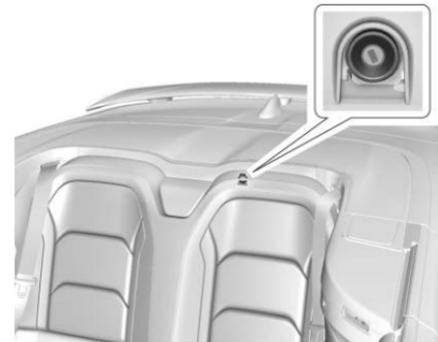
2. Localiser le déverrouillage manuel à côté du coussin de siège arrière, côté conducteur.
