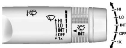
La manette d'essuie-glace/lave-glace avant se trouve sur le côté droit de la colonne de direction. Avec le contact allumé ou en position ACC/ACCESSORY (accessoires), déplacer le levier d'essuie-glaces pour sélectionner la vitesse de balayage.
