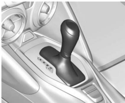
La fonction de commande de vitesses de conducteur (DSC) permet de changer les rapports d'une boîte de vitesses automatique comme avec une boîte de vitesses manuelle. Pour utiliser la fonctionnalité de commande de vitesses de conducteur (DSC) :
