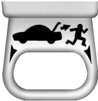
Il existe une poignée fluorescente de déverrouillage de secours du coffre sur le couvercle de coffre. Cette poignée brille en fonction de son exposition à la lumière. Tirer sur la poignée de déverrouillage pour ouvrir le coffre depuis l'intérieur.
