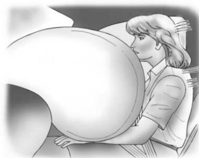
L'airbag frontal du passager extérieur avant se trouve dans le tableau de bord côté passager.
