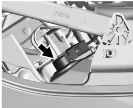
3. Tourner la douille d'ampoule dans le sens antihoraire afin de l'enlever du bloc de phare.
