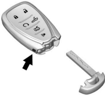
La clé, à l'intérieur de l'émetteur d'entrée à distance sans clé (RKE), peut être utilisée pour toutes les serrures.
